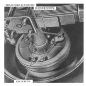
FIG. 28 -- BRAKE ADJUSTMENTS
